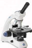
Oculaire grand champ WF 10x/18mm avec pointeur, tête monoculaire rotative sur 360°, inclinée à 45°, objectifs semi-plan 4x, 10x, S40x (rétractable) et S60x (rétractable), éclairage à LED 1W.
