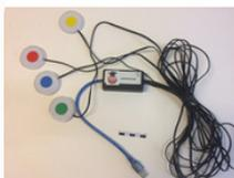
Permet de mesurer la vitesse des ondes sismiques dans différents types de matériaux, et la localisation simple d'un choc.
